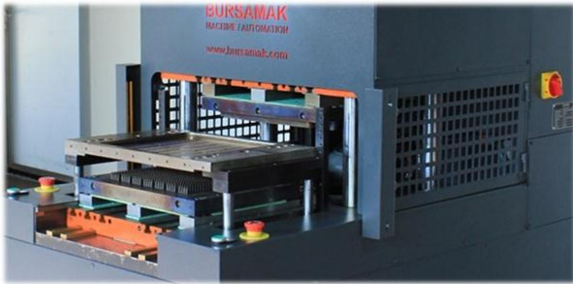
Les éjecteurs centraux et latéraux à commande hydraulique permettent d'éjecter automatiquement les produits du moule. Ceci réduit considérablement le temps de production et augmente le volume de production.
