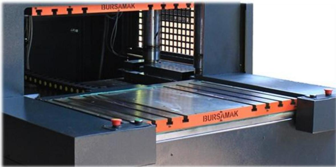
La table inférieure coulissante hydraulique amène le moule devant l'opérateur, facilitant ainsi le chargement et le déchargement. Grâce à une moindre amplitude de levage de la table supérieure et à une meilleure aisance de travail, votre temps de production est considérablement réduit.
