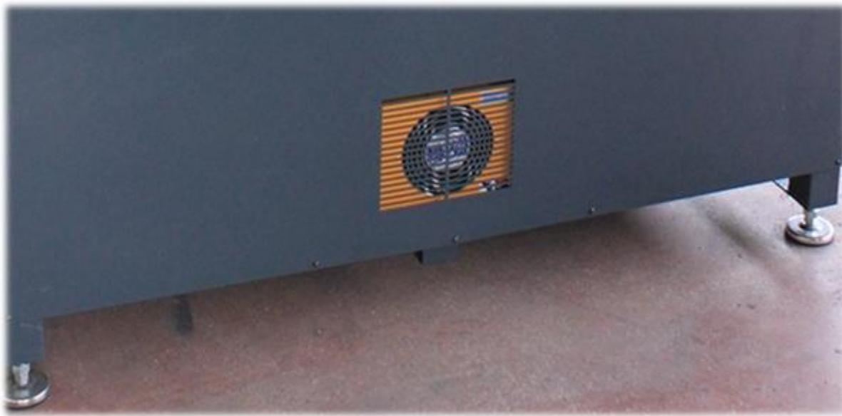
Grâce au système de refroidissement d'huile intégré à nos presses, la machine refroidit automatiquement l'huile hydraulique lorsque la température dépasse celle que vous avez spécifiée, ce qui vous évite toute perte de puissance et prolonge la durée de vie de vos feutres.
